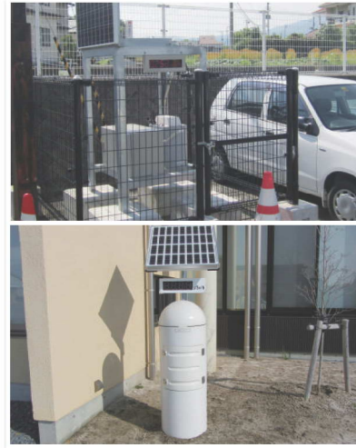
写真上：文部科学省が設置した可搬型モニタリングポスト。平成24年4月28日から測定を開始した 写真下：各地区の公民館などに設置されたリアルタイム線量計
