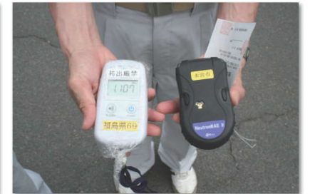
右は、平成23年3月29日から市独自の測定に使用していた測定器（米国RAEsystem社製NeutronRAE II）。左は、主に町内会・行政区や個人の貸出し用として使用していた線量計（堀場製作所製Radi PA-1000）
