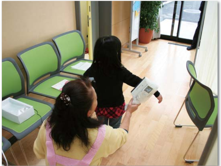
(右) 測定前には衣服などに放射性物質が付着していないか専用のサーベイメータで測定します (左) 測定後、すぐに検査結果をお知らせします
