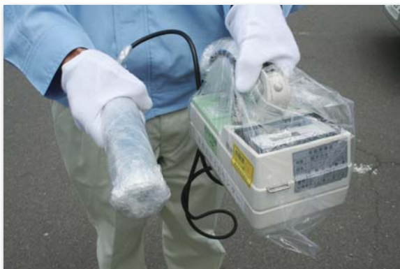
平成23年3月17日から福島県が測定に使用していたシンチレーションサーベイメーター
