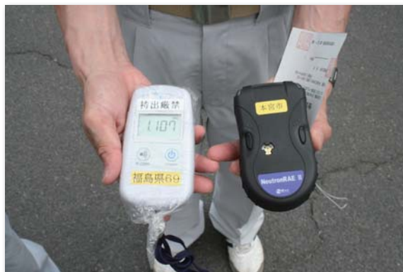
右は、平成23年3月29日から市独自の測定に使用していた測定器（米国RAEsystem社製NeutronRAE II）。左は、主に町内会・行政区や個人の貸出し用として使用していた線量計（堀場製作所製Radi PA-1000）
