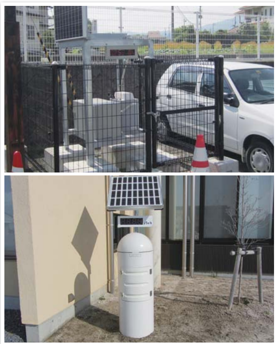
写真上：文部科学省が設置した可搬型モニタリングポスト。平成24年4月28日から測定を開始した 写真下：各地区の公民館などに設置されたリアルタイム線量計
