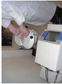
▲本宮市幼保学校給食センターの検査の様子。玄米検査結果の最高値(セシウム)は16.11ベクレル/kgでした
