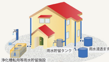
浄化槽転用等雨水貯留施設
