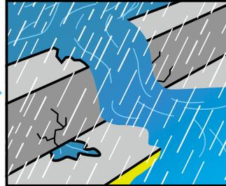
溢れ出した水により、堤防の一部が崩れ始めます。
