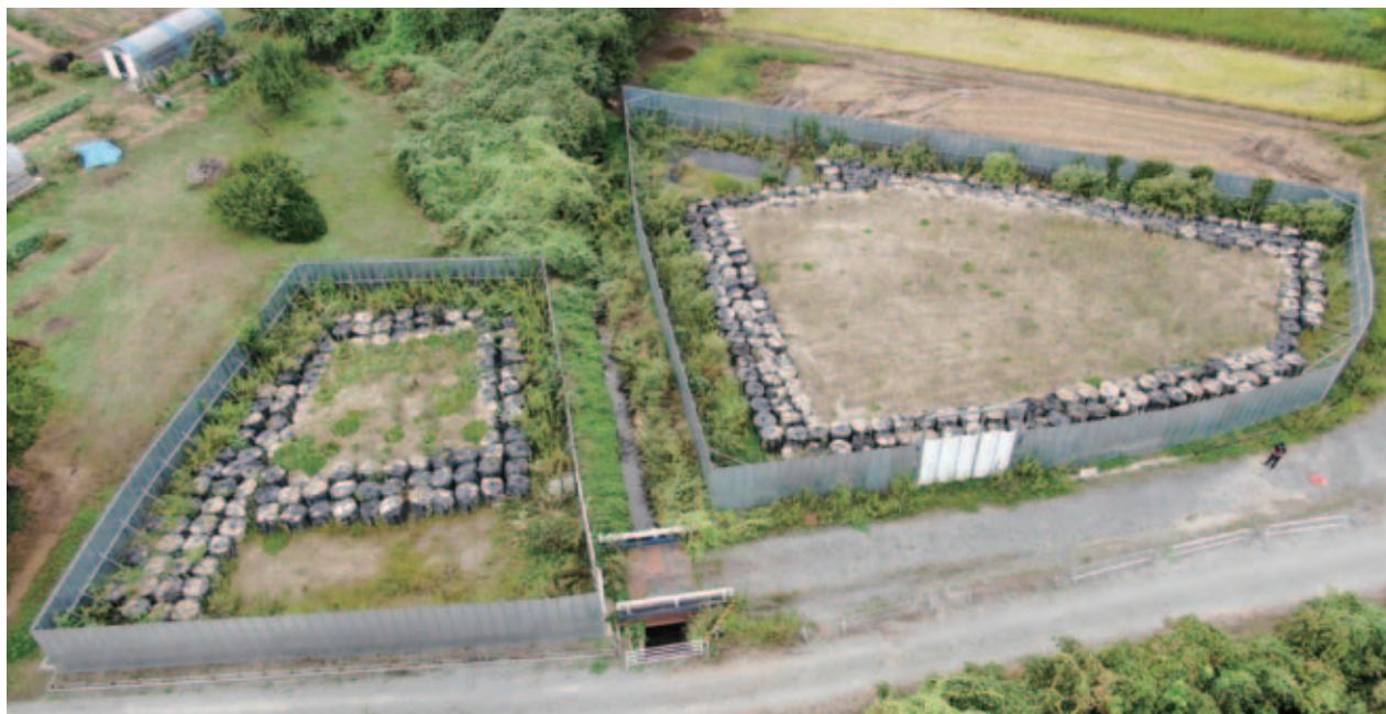
▲今後仮置場の原形復旧が進められる（黒い土のうは遮蔽土のうのため汚染されていない）
